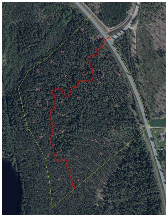
Figur 11: Befintlig dagvattenavrinning inom planområdet. Delningsrygg enligt röd linje.
