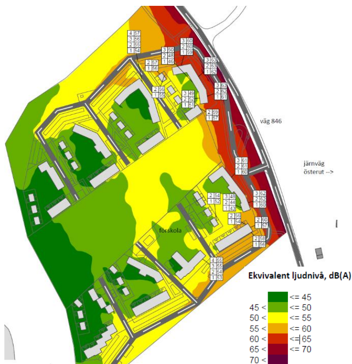
Figur 18: Ekvivalent dBA-nivå vid fasad.
