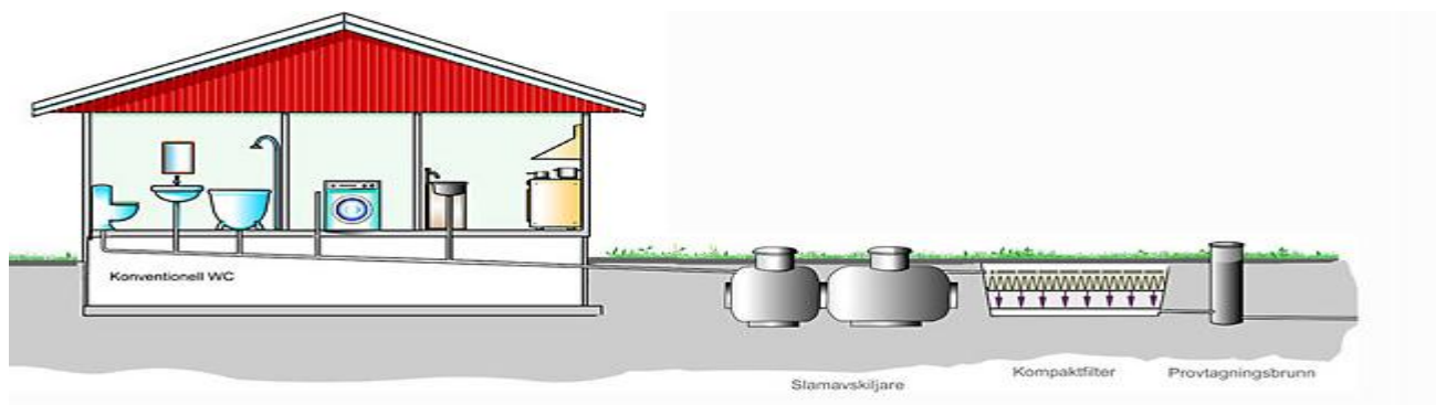
Bild: Principskiss för kompaktfilter eller biomoduler ( www.avloppsguiden.se )
